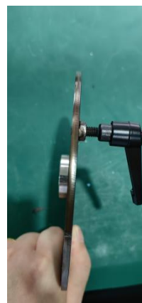
(3) 顶杆扳手安装在吸盘上
