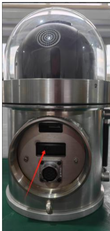
(1) 用手拨动中间孔位左右寻找卡槽位置
