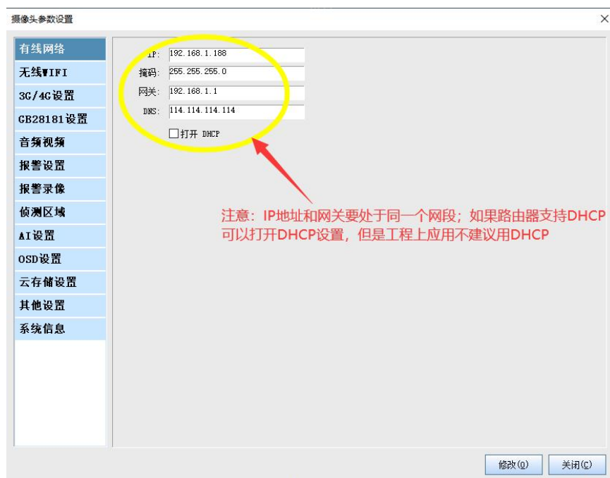
图2.5 修改IP地址
